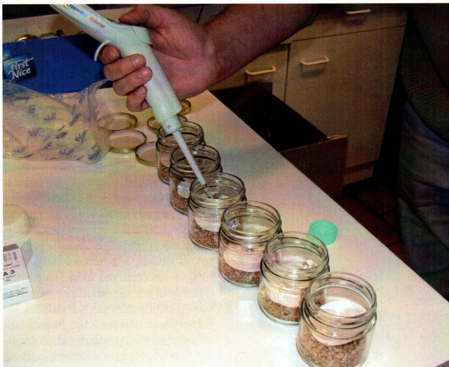
Obrázek 2: Aplikace EO mikropipetou na filtrační papír
